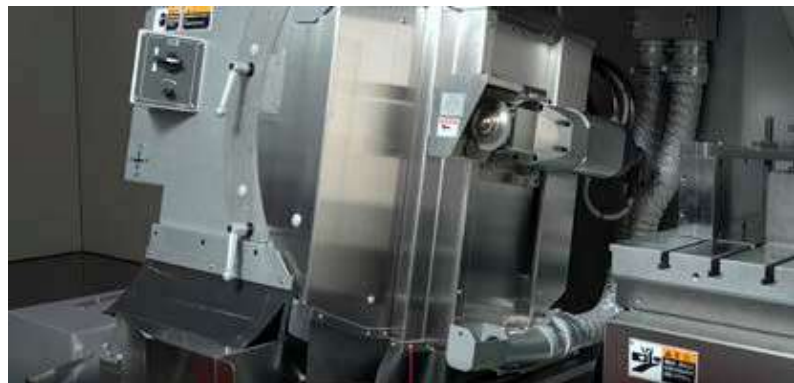
Positionnement tête de rectification sur plus de 6 axes et table de travail plus de 3 axes.
