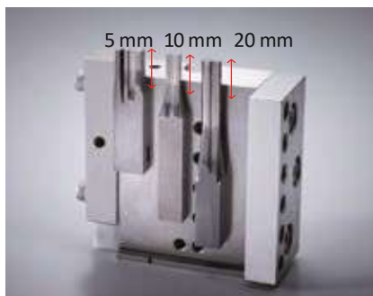
Utilisation d'un moteur linéaire – Positionnement automatique, différentes courses, longueurs et vitesses dans le même programme
