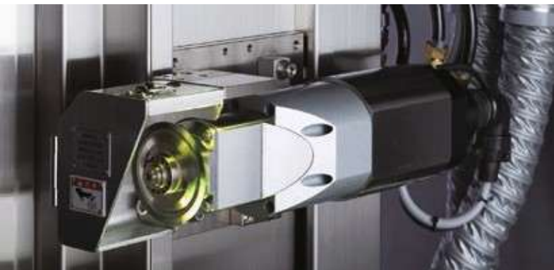
Course du battement de meule à moteur linéaire programmable
