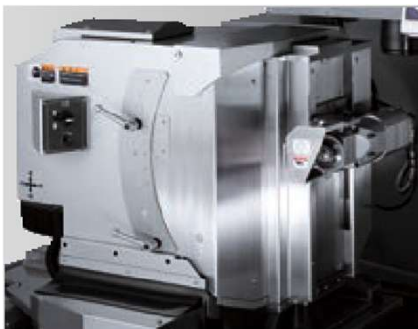
Utilisation d'un moteur linéaire – Positionnement automatique, différentes courses, longueurs et vitesses dans le même programme
