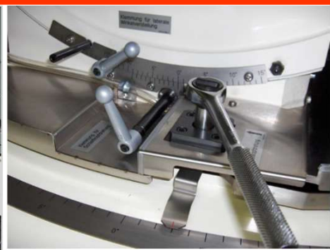
Règles de mesures résolution 50 nanomètres
