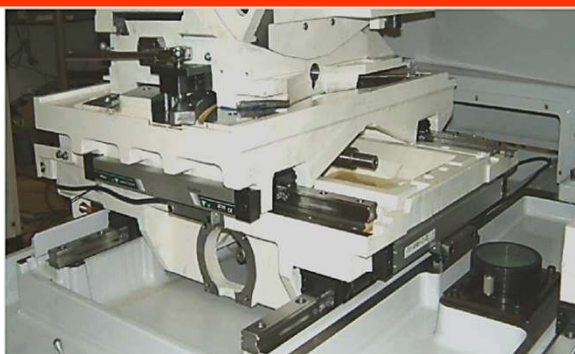
Bâti et composants en Fonte
