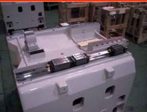
Bati fonte et guidages de la table
