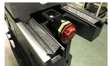
Glissières grattées à la main
