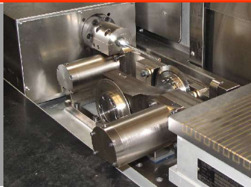
TPA + VPA Ebauche et finition avec disques diamants
